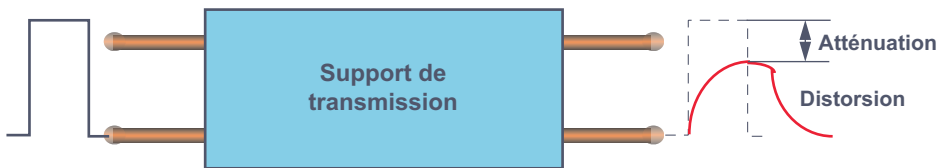
Figure 4.2 Déformation du signal par le support de transmission.
