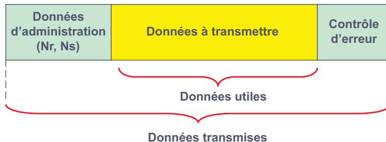
Figure 6.21 Structure de base d'un bloc d'information.
