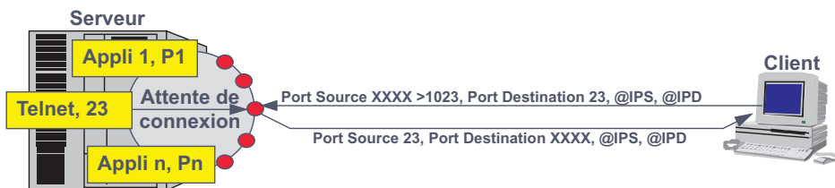
Figure 10.48 Le référencement de la connexion de transport.
