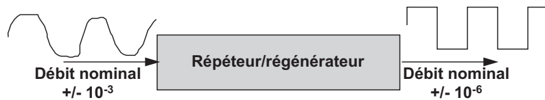
Figure 11.5 Régénération du signal par un répéteur.
