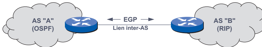
Figure 14.42 Connectivité de deux systèmes autonomes.
