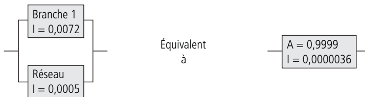
Figure 20.71 Branche 1 et réseau de l'opérateur.
