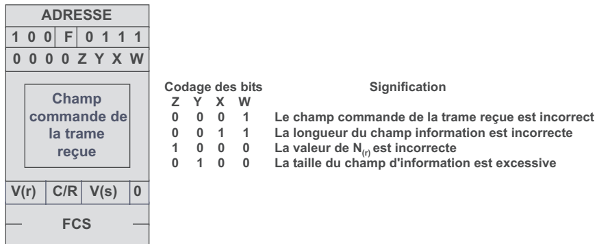
Figure 11.32 Trame d'indication d'erreurs FRMR.
