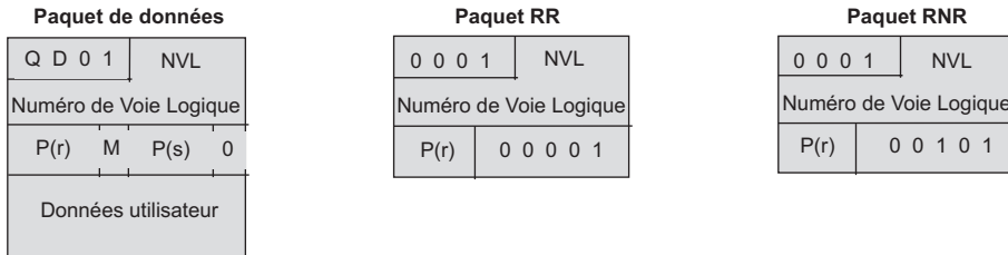
Figure 11.41 Format des paquets de données, d'acquittement et de contrôle de flux.
