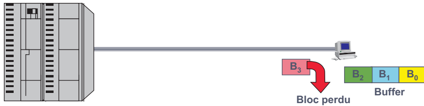
Figure 6.31 Nécessité d'instaurer un contrôle de flux.
