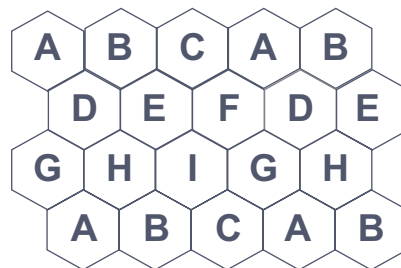
Figure 15.39 Organisation des cellules utilisant 9 jeux de fréquence de base.
