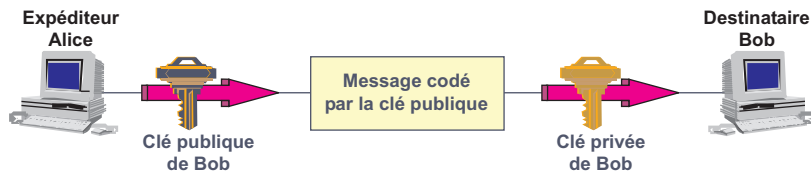
Figure 17.12 Principe de la cryptographie à clé publique.
